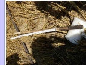
Bodenprofil im 1m-Bohrstock.
