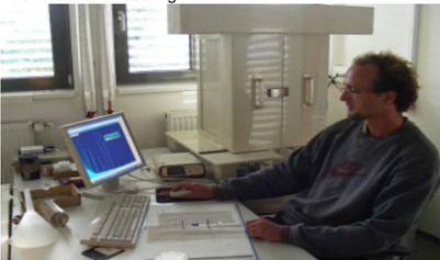
Auswertung der Gammaskpektrometriemessung (im Hintergrund zu sehen ist die Bleiburg, in der sich der Detektor befindet)
